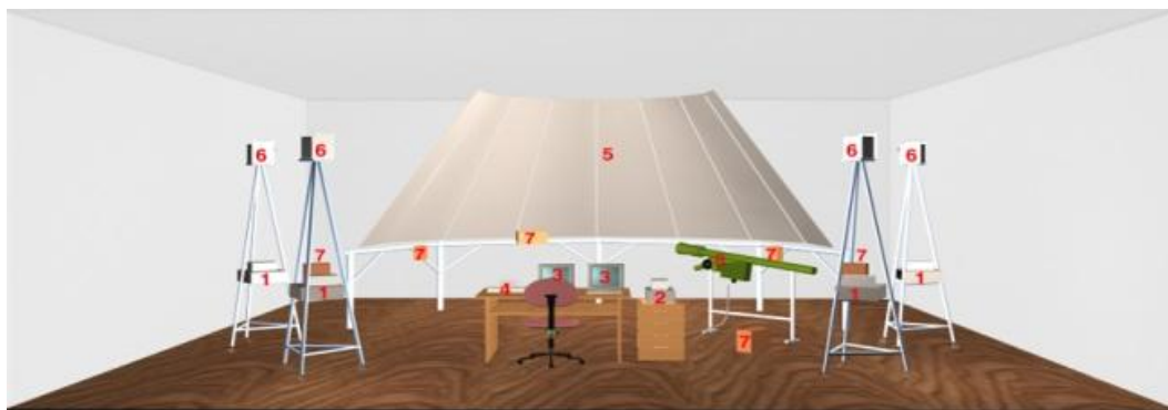
Рис. 6. Динамический тренажер для стрелков-зенитчиков
