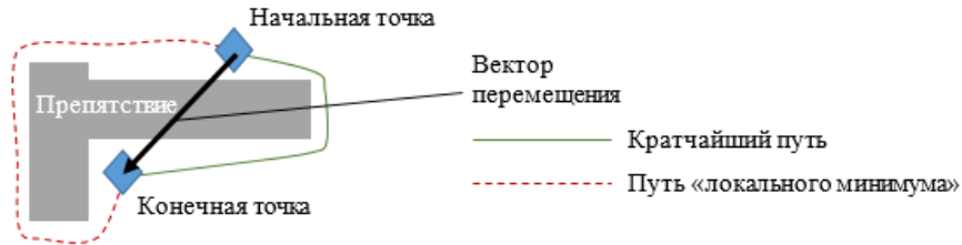
Рисунок 4. Пример локального минимума при поиске траектории на плоскости
